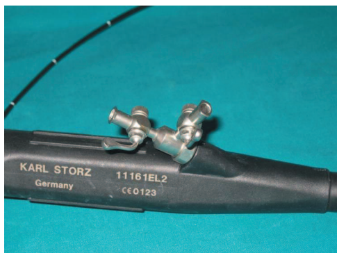
рис. 3: Манипуляционные каналы текалоскопа (диаметр 1,2 мм).
