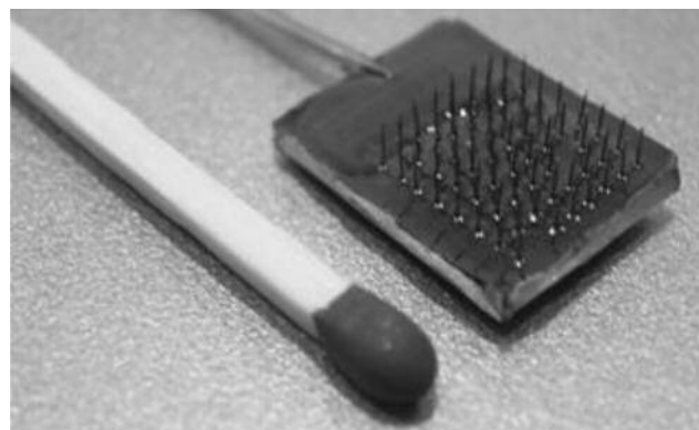
рис. 2: 64-канальная микроэлектродная матрица фирмы «НейроКоннекс»
