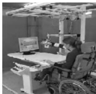
рис. 2: Первый бимануальный робот для тренировки рук MIME
